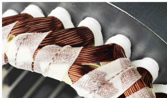
Концы катушки всегда изготавливаются в пределах размерных допусков.
