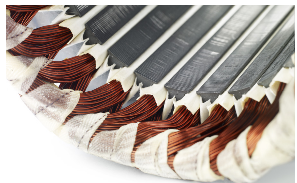
Эффективная футеровка пазов.
