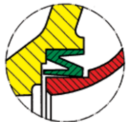
Кольцо износа в ходе эксплуатации
