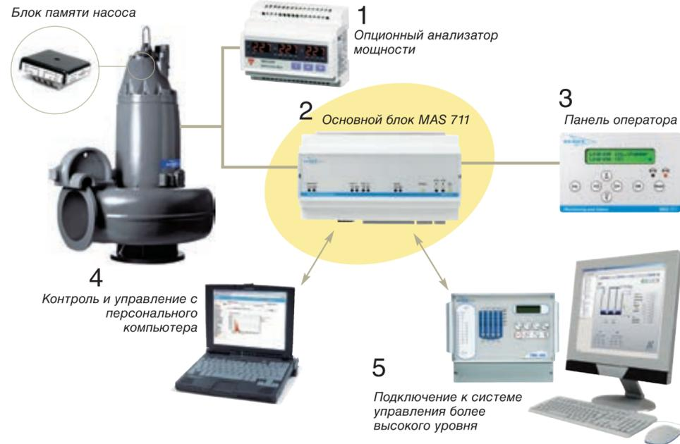
Комплект сенсоров, выбранных заказчиком, устанавливается на заводе во время сборки насоса. При установке насоса на площадке их характеристики автоматически загружаются в основной блок, что значительно упрощает настройку насоса к работе и обеспечивает безопасность благодаря использованию соответствующих параметров аварийных сигналов. Система разработана на основе многолетнего опыта компании Flygt.
